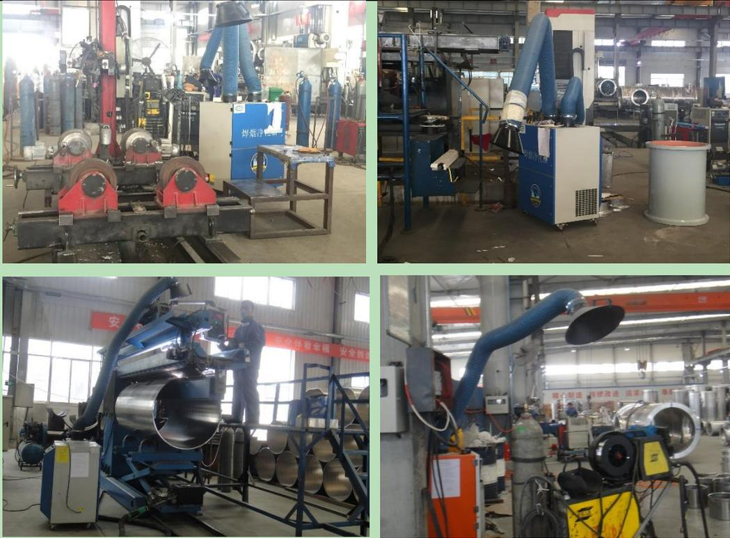
图 3-3 移动式焊烟净化器
