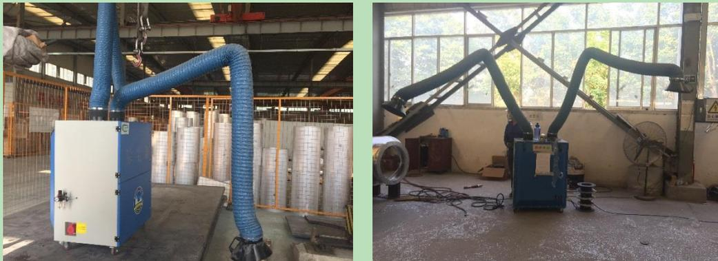
图 3-4 移动式粉尘除尘器
