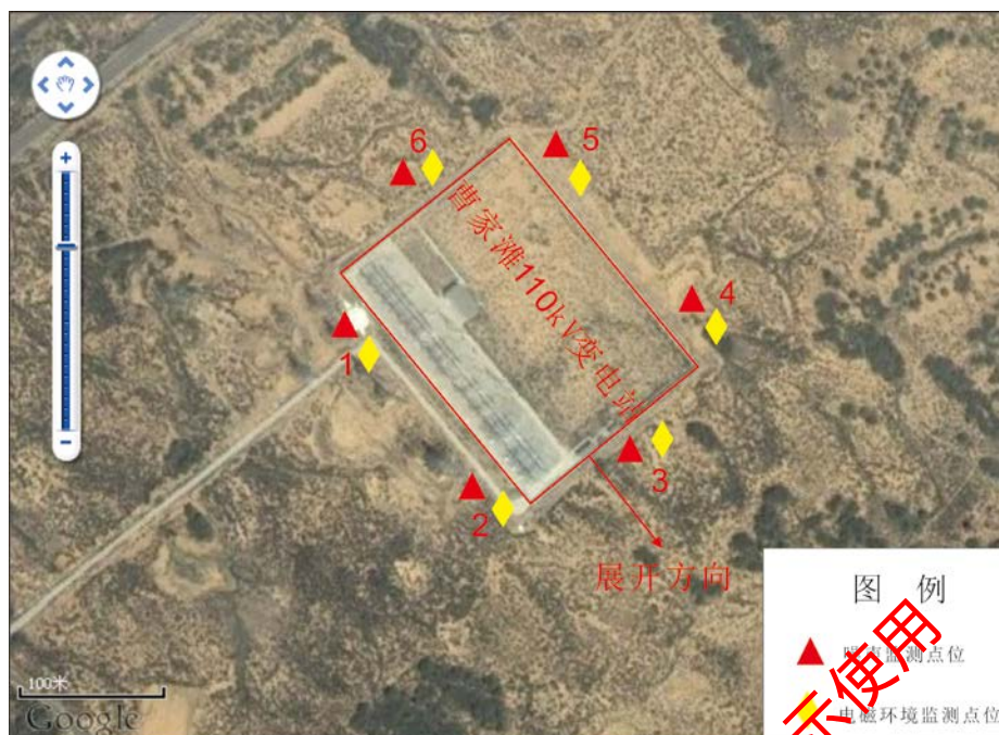
图1 曹家滩 110kV 变电站总平面布置及监测点位示意图
