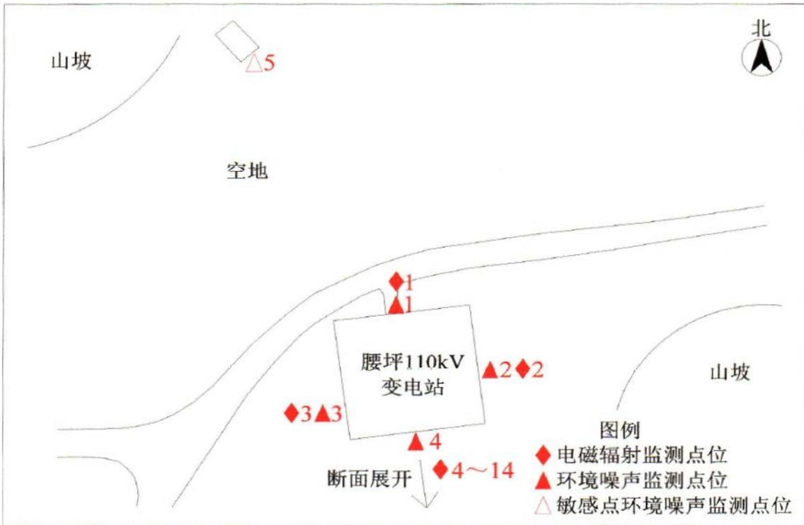
图1 腰坪 110kV 变电站总平面布置及监测点位示意图
