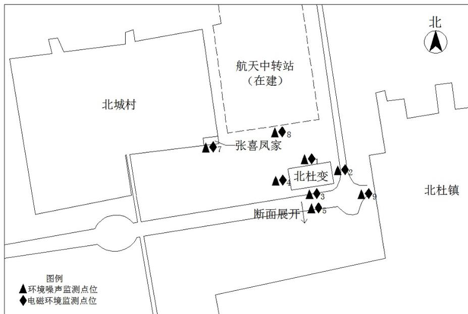
图2 北杜 110kV 变电站监测点位示意图
