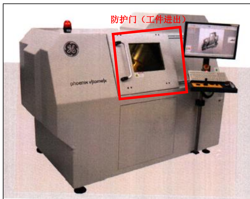
图 9-3 v|tome|x s 240 三维 CT 设备
