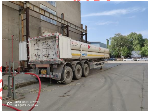
CNG 槽车及管道阀门
