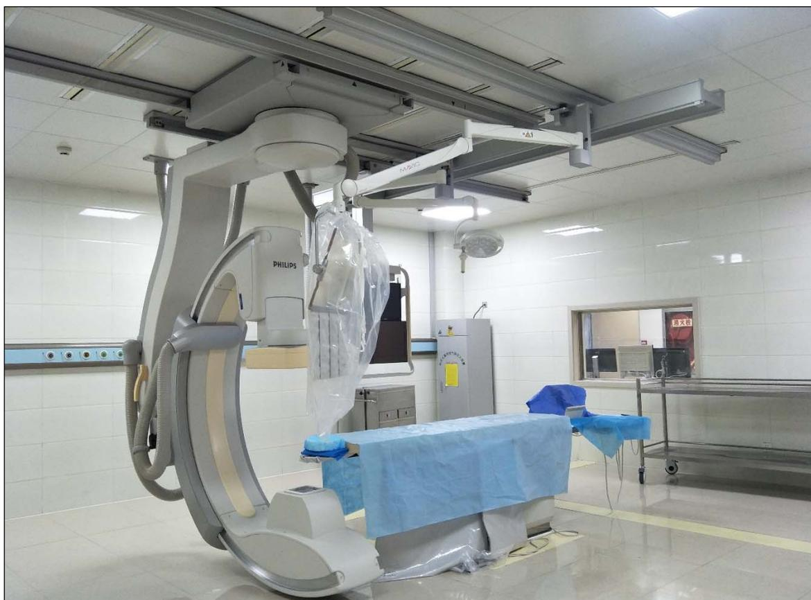
图 1-4 Philips UNIQ FD20 型医用血管造影 X 射线系统 (DSA)
