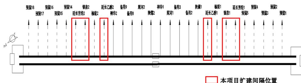
图 1 沙井 330kV 变电站间隔扩建示意图
