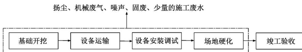
图 4 沙井 330kV 变电站间隔扩建工程施工期工艺流程及产污环节示意图
