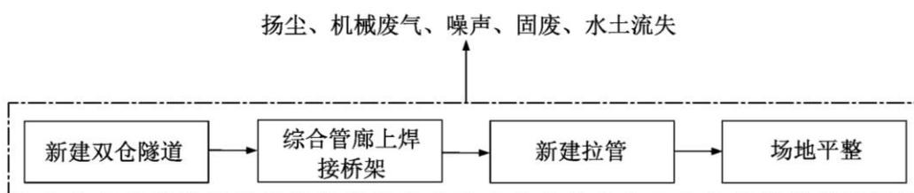
图 5 电缆线路间隔扩建工程施工期工艺流程及产污环节示意图
