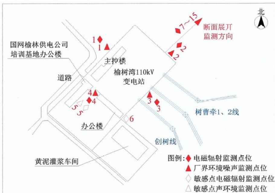
图 1 榆树湾 110kV 变电站平面布置图及监测点位
