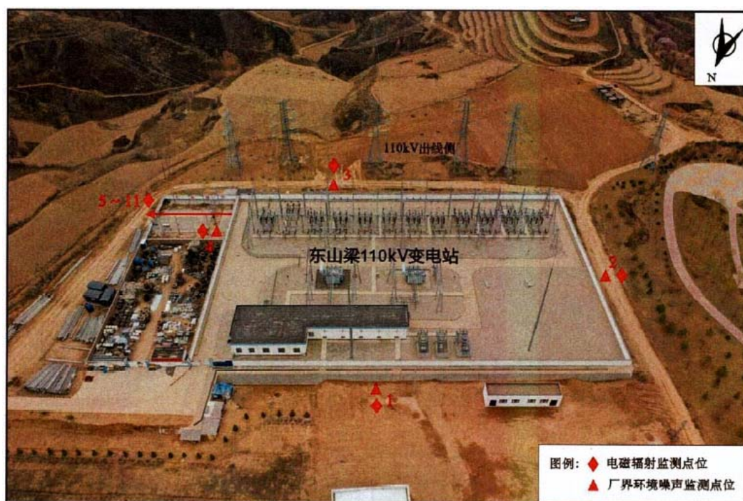
图 7.2-1 东山梁 110kV 变电站监测点位图
