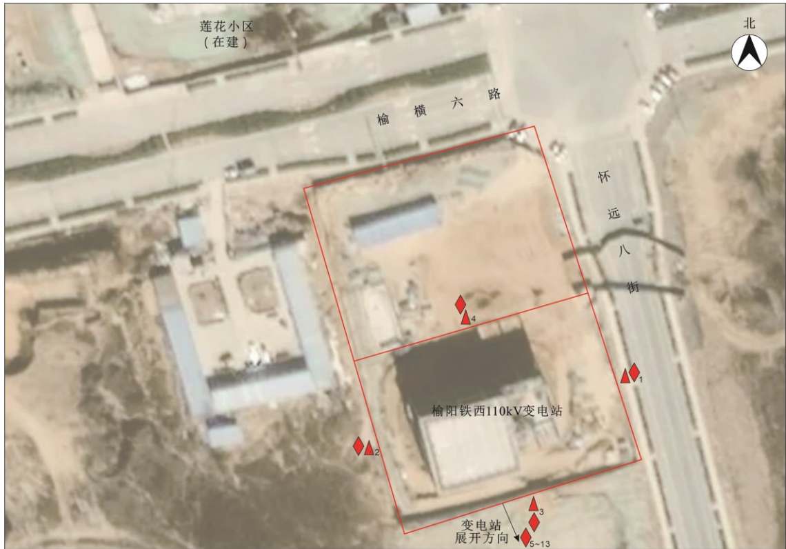
图 7.1.2-1 铁西 110kV 变电站监测点位图
