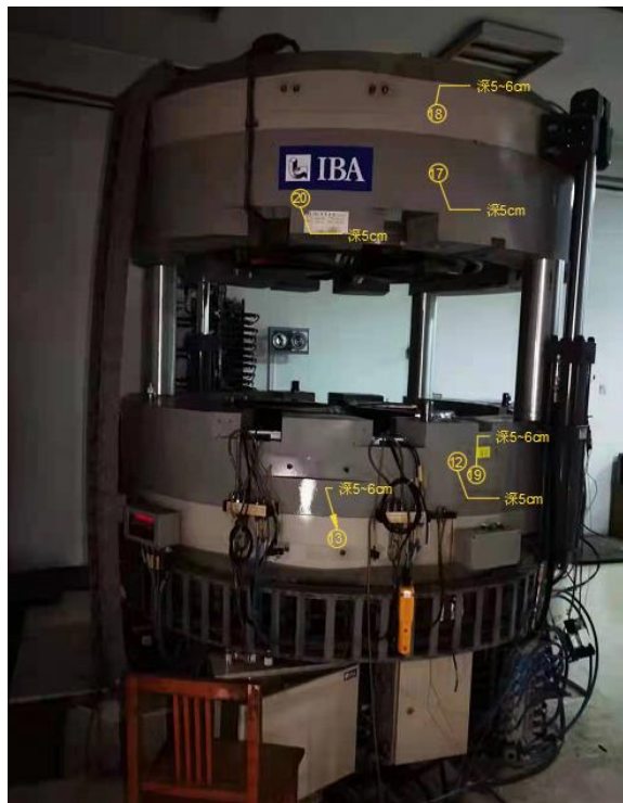
图 9-3 安迪科 IBA 回旋加速器侧面取样点位示意图
