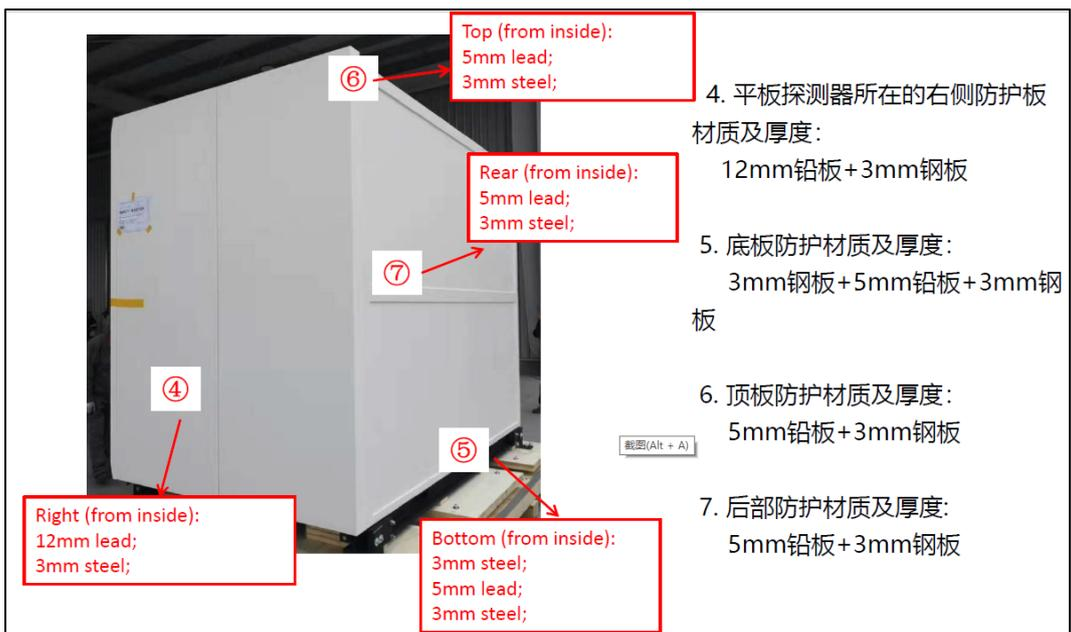
图 10-4 工业 CT 背面、右侧及顶部屏蔽防护情况示意图
