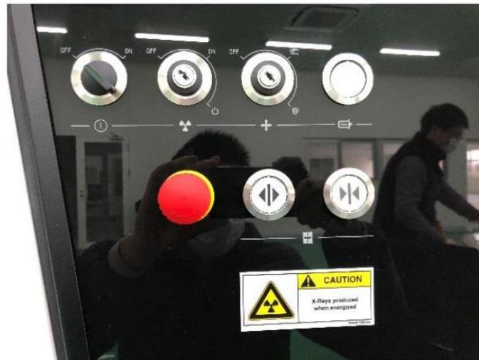
图 10-10 控制面板钥匙开关、急停按钮、辐射警示标志等
