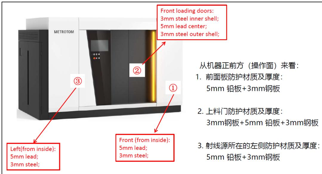
图 10-3 工业 CT 正面及左侧屏蔽防护情况示意图
